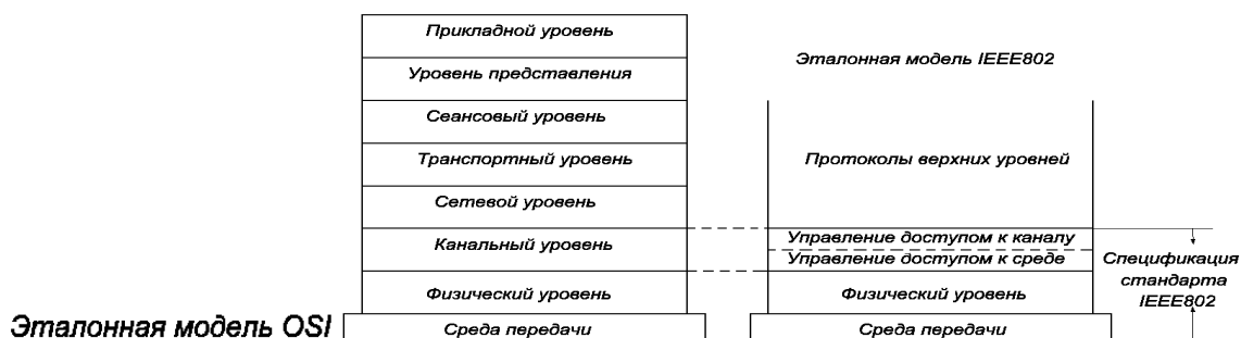
Рисунок 1. Сопоставление моделей OSI и IEEE 802
